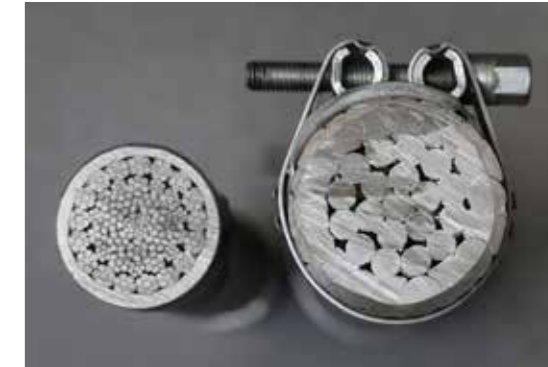
Dünne Drähte werden zu Litzen. Die Litzen verdrillt man schließlich zum Endprodukt, das aus 1000 einzelnen Drähten gefertigt sein kann.
